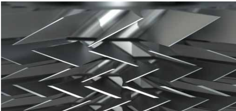
图2：转子和定子叶片的排列方式
