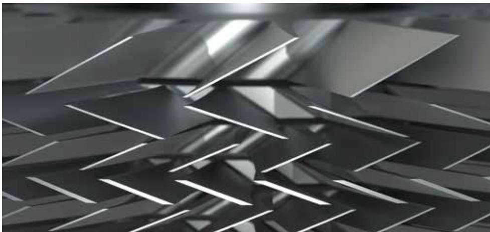
그림 2: 회전자 및 고정자 블레이드의 배열
