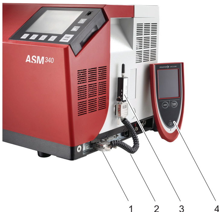
Abb. 3: Funktransmitter und Fernbedienung am Lecksuchgerät montiert
