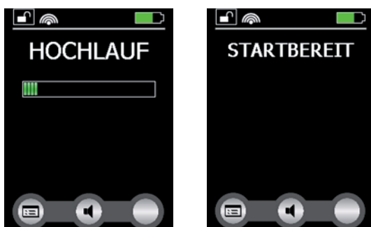
Abb. 11: Wiedergabe des Lecksuchgerät-Displays auf der Fernbedienung (Beispiele)
