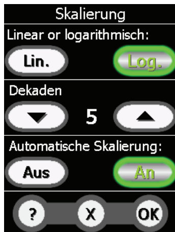
Abb. 10: Skalierung der Q(t)-Achse einstellen
