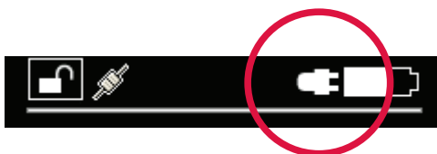
Abb. 16: Beim Aufladen wird das Steckersymbol in der Kopfzeile angezeigt
