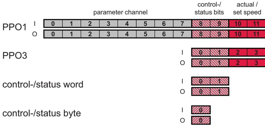
그림 4: Profibus 모듈 그림
