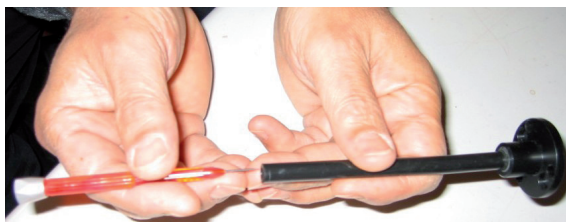
Abb. 6: Kapillare aus der Schnüffelspitze herausdrücken
