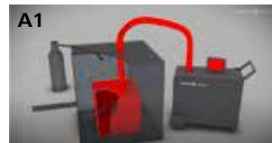
Integrale Prüfung von Teilen unter Vakuum in Helium
