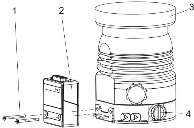
그림 18: 전자 드라이브 유닛 설치 및 제거
