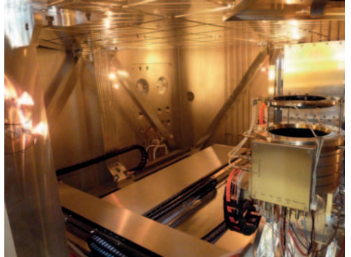
그림 2: IBF-2000의 챔버 내부에서 3축 조작 시스템을 사용하여 직경이 최대 2,000 mm인 공작물을 가공할 수 있습니다.
