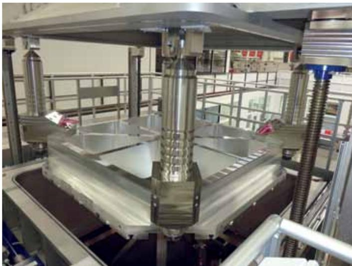
Abbildung 3: Mit einer speziellen Hebevorrichtung werden die Werkstücke in die Kammer transportiert
