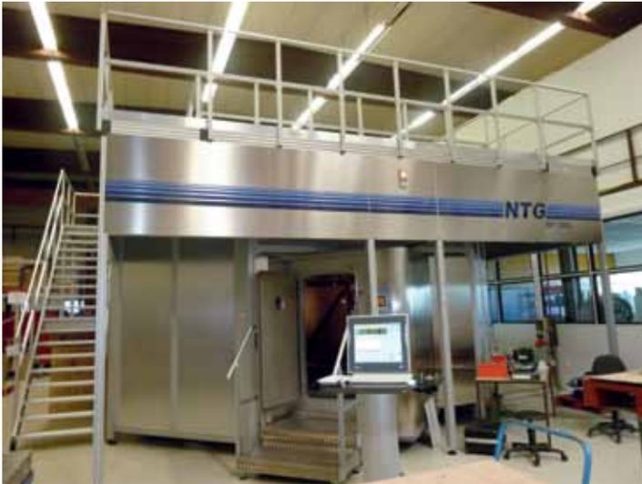
Abbildung 1: Die IBF-2000 ist die aktuell größte Ionenstrahlbearbeitungsanlage der Welt
