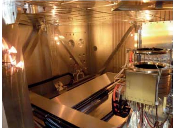
Abbildung 2: Mithilfe eines 3-Achsen-Bewegungssystem können in der Kammer der IBF-2000 Werkstücke mit einem Durchmesser bis zu 2.000 mm bearbeitet werden
