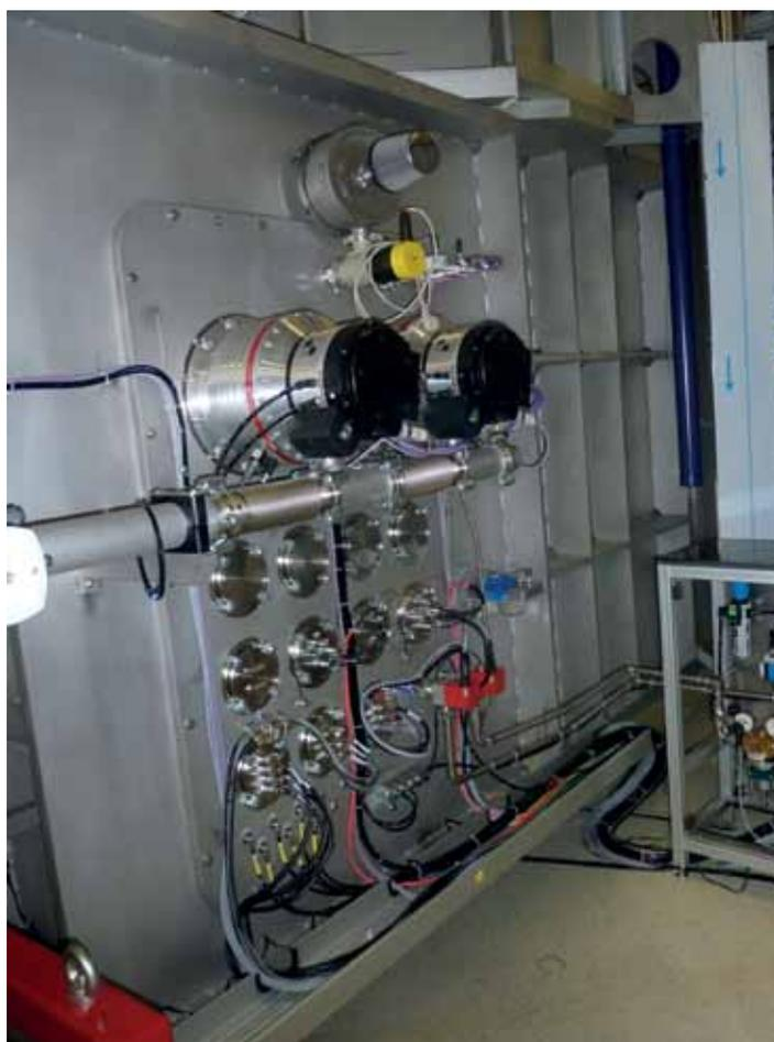
Abbildung 6: HiPace Turbopumpen im Einsatz an der IBF-2000
