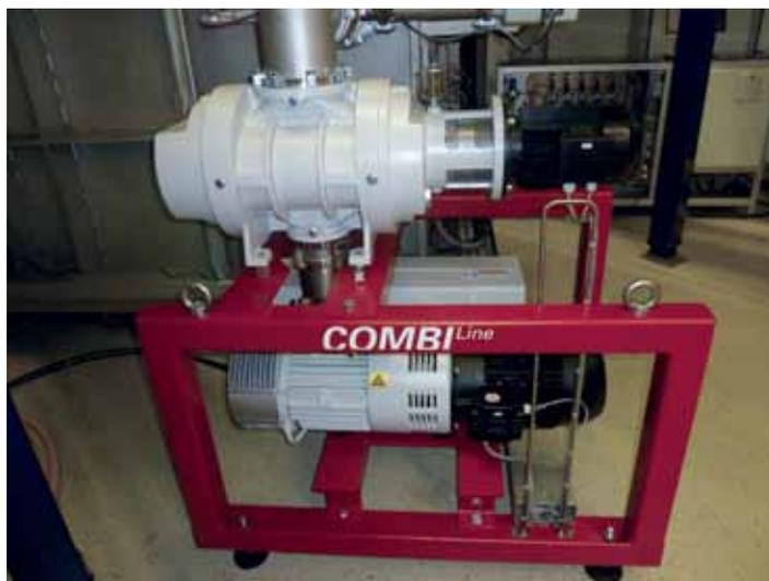
Abbildung 5: Der CombiLine Pumpstand von Pfeiffer Vacuum in der IBF-2000
