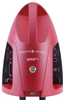
그림 6: 파이프 베큘의 휴대용 리크 감지기와 휴대용 케이스
