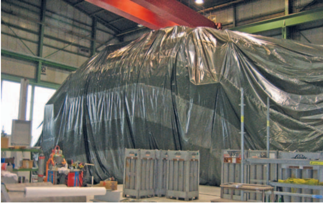
그림 2: 포일로 감싼 분광분석기 탱크를 보면 엔지니어가 포장에 얼마나 신경을 써야 했는지 알 수 있습니다.
