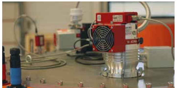
그림 5: Levisys에서 사용되는 파이퍼 베콤의 터보 펌프, 회전 날개 펌프, 피라니 측정기
