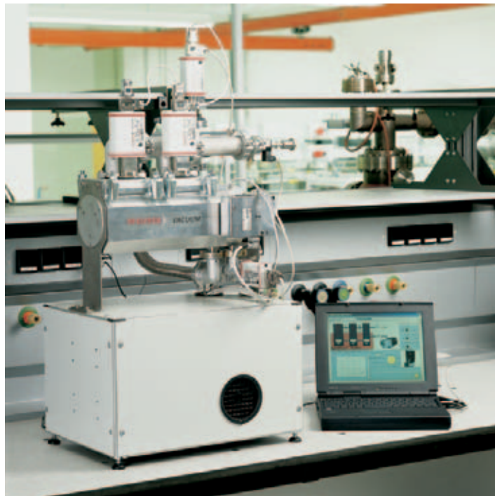
图3：普发真空 SplitFlow™概念的定制涡轮分子牵引泵的典型应用
