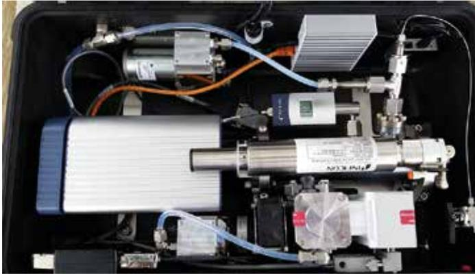
그림 4: Inficon 분석기와 송신기, 파이프 베콤 HiPace 10 터보 펌프, MVP003-2 다이어프램 펌프를 장착한 24 V DC 버전의 이동식 질량 분석기 시스템
