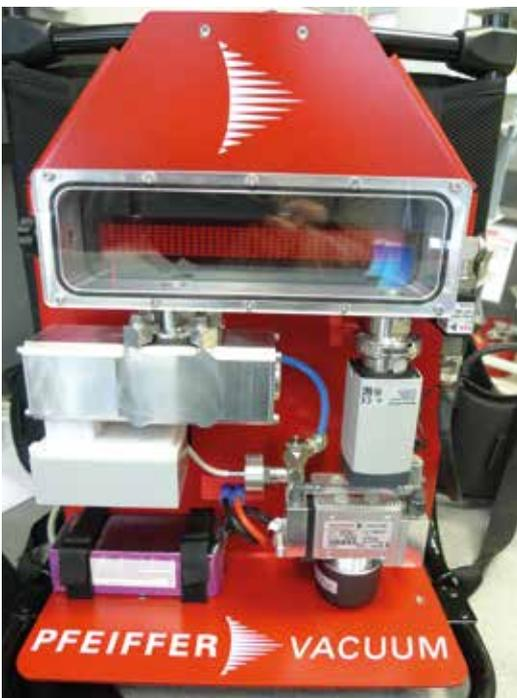
그림 2 및 3: 파이퍼 베콤의 질량 분석용 휴대용 진공 시스템
