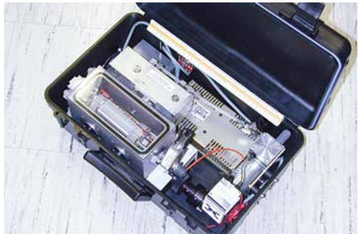
그림 1: 미국 볼티모어 소재 존스 홉킨스 대학에서 사용 중으로 파이퍼 베콤의 진공 장비를 장착한 질량 분석기 시스템
