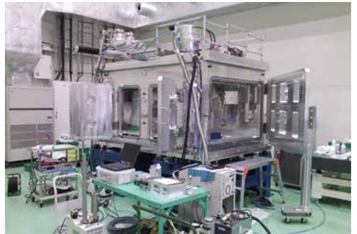
그림 6: 파이퍼 베콤 솔루션을 갖춘 European XFEL의 인터랙션 챔버 (© European XFEL)
