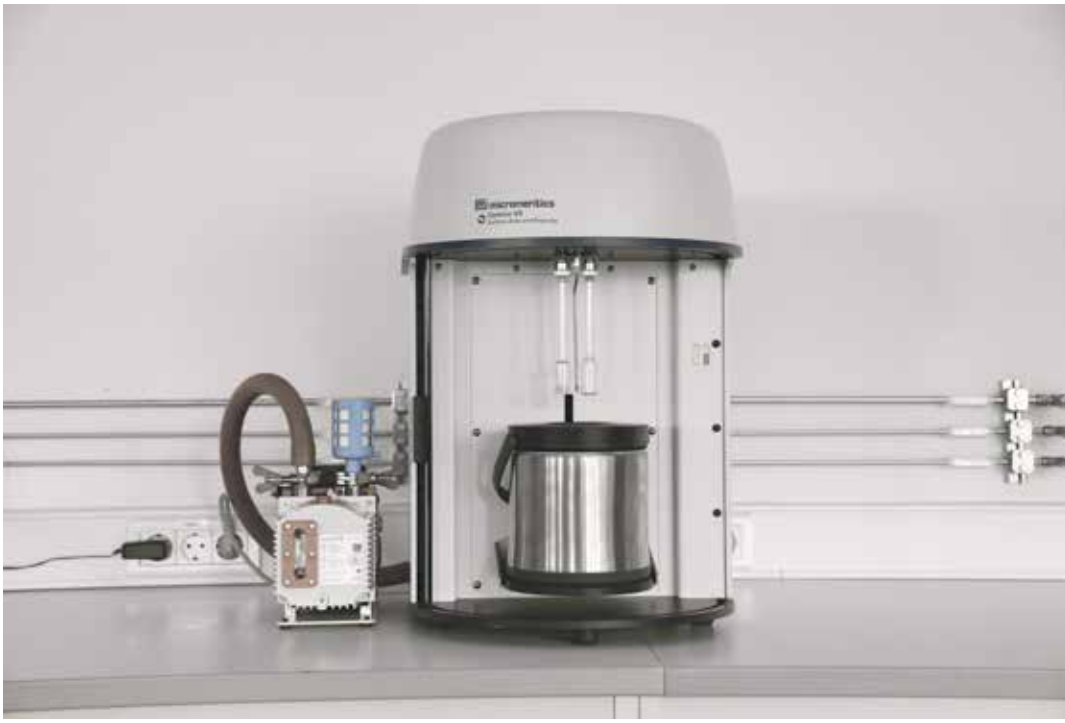
사진 1: Micromeritics GmbH 에서 표면 분석에 사용하고 있는 파이프 베큘에서 제작한 Duo 1.6 회전 날개 펌프.
