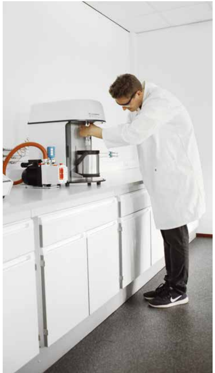
사진 2: Micromeritics GmbH에서 파이퍼 베콤의 회전 날개 진공 펌프를 사용해서 샘플을 준비하고 물리 흡착을 측정하는 모습.
