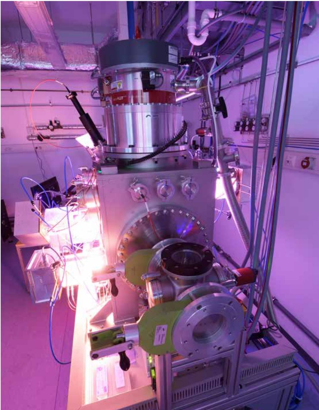
그림 3: 이온 빔 스퍼터 증착 방식으로 양면에 기판을 코팅하기 위해 여러 RF 이온 소스를 사용하는 2DIBS 시설. 이 시스템에는 ACP 28 배압 펌프와 ATH3204M 유형의 터보 펌프 2대도 장착되어 있습니다.
