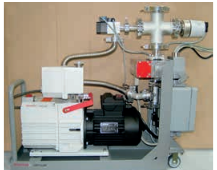
图 1：定制的太阳能吸热器脱气泵车
