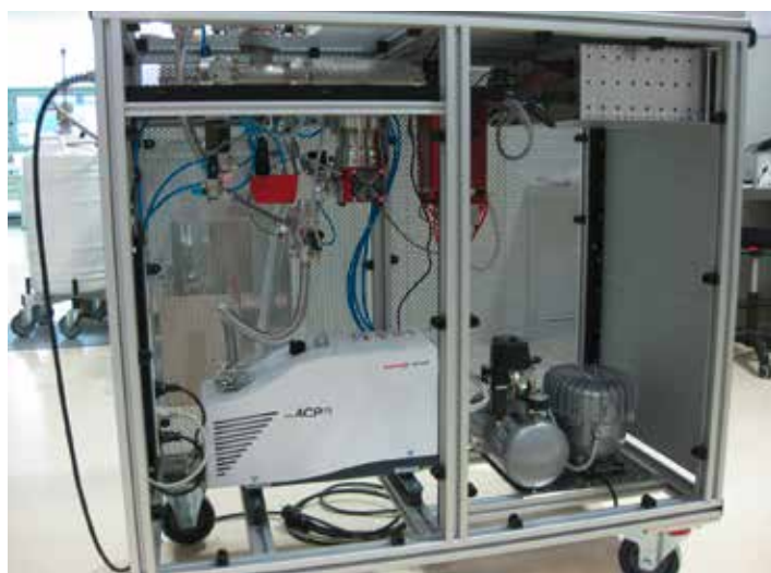
应用范围极广的特制检漏仪。从 H 2 到 Xe，所有气体均可检测，并且适用压力范围广泛。
