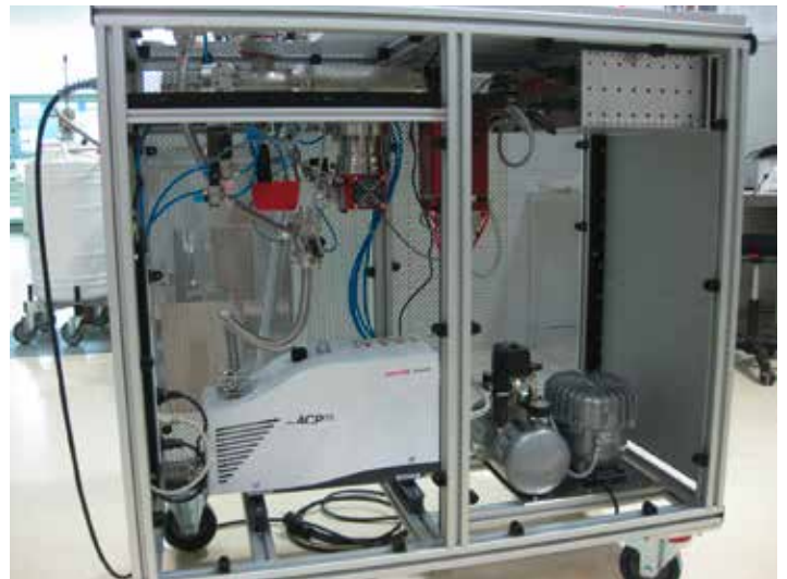
Spezieller Lecksucher für einen sehr breiten Anwendungsbereich. Es können alle Gase von H 2 bis Xe über einen weiten Druckbereich detektiert werden.
