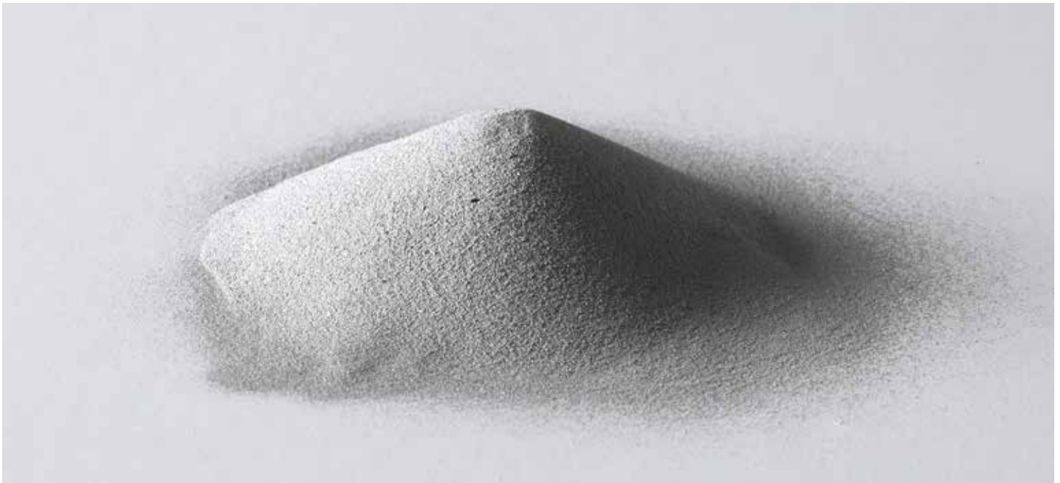
그림 4: 3D 프린팅을 위한 금속 분말, 티타늄 및 코발트-크롬의 합금이 종종 사용됨 © Courtesy of Arcam AB
