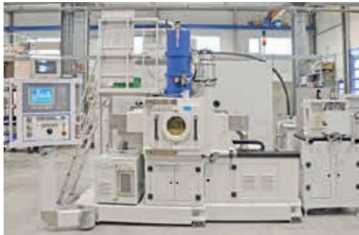
사진 1: 용접 챔버를 갖춘 전자빔 용접기와 전자빔 발생기 (Steigerwald Strahltechnik 제공)
