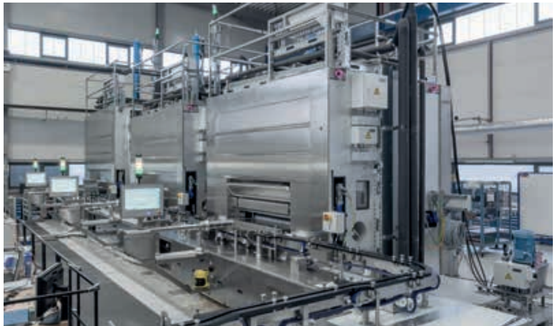
OPTIMA pharma GmbH에서 설치된 생산 냉동 건조기 OPTIMA pharma GmbH 현장 모습
