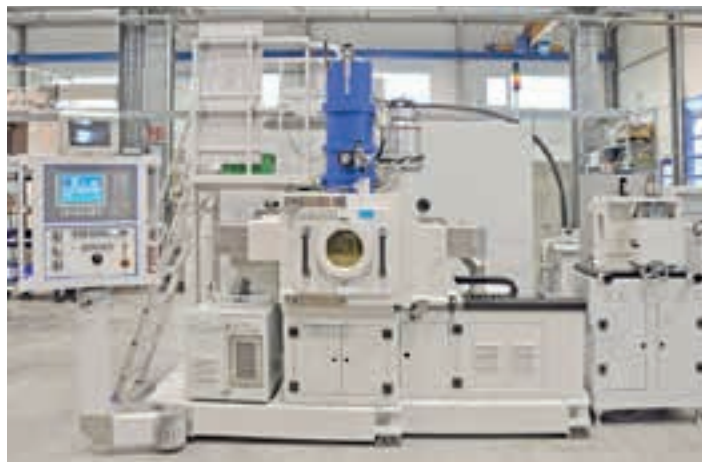
Abbildung 1: Elektronenstrahlschweißanlage mit Schweißkammer und Elektronenstrahlgenerator (Mit freundlicher Genehmigung von Steigerwald Strahltechnik)
