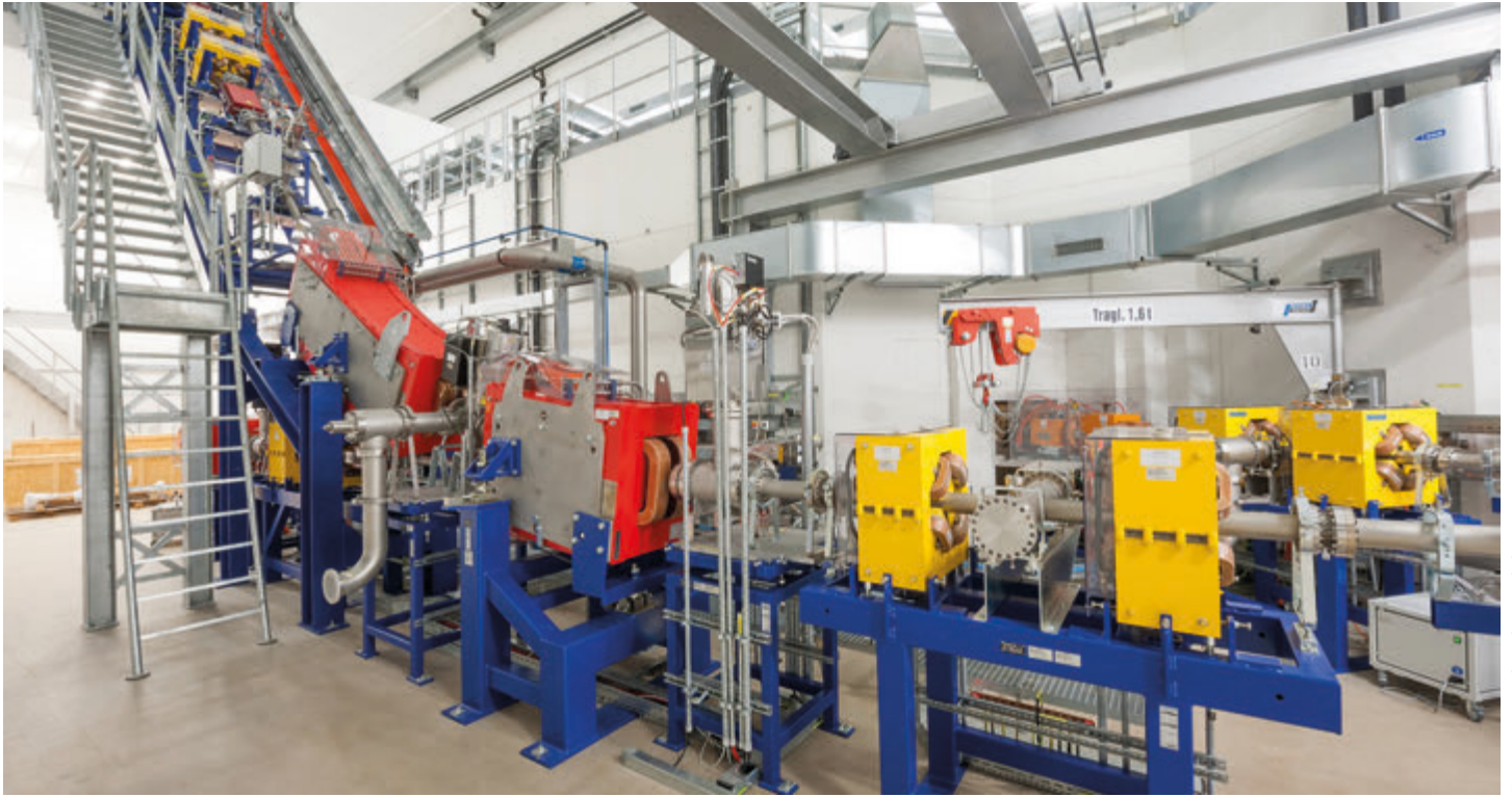
그림 4: 파이프 베콤 솔루션을 이용한 45° 방사 스테이션으로의 빔 유도 시스템
