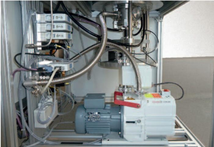
Das im Prozess benötigte Vakuum erzeugen Drehschieberpumpen der DuoLine Serie.
