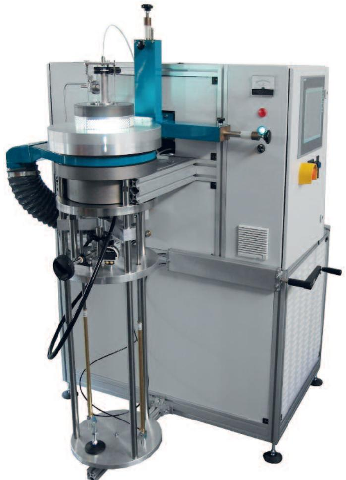
Das Herzstück des Plasmasystems bildet ein flacher Stahlzylinder mit aufwendigen feinen Bohrungen, durch die das Gas einströmt. Im Inneren leuchtet das in den Plasmazustand versetzte Gas.
