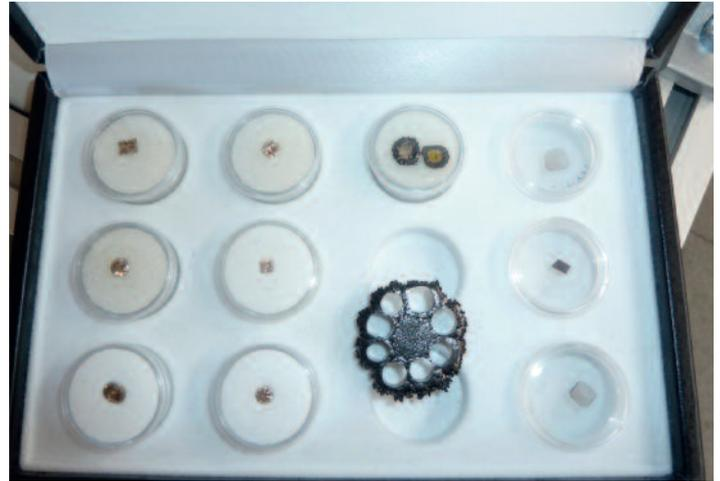
Auf der rechten Seite sind die Wafer zu sehen, auf denen der Diamant im Plasma wachsen wird. In der Mitte ist der sich abscheidende Graphit aus dem Gasgemisch gezeigt. Die geschliffenen, synthetisch erzeugten Diamanten sind auf der linken Seite zu sehen.
