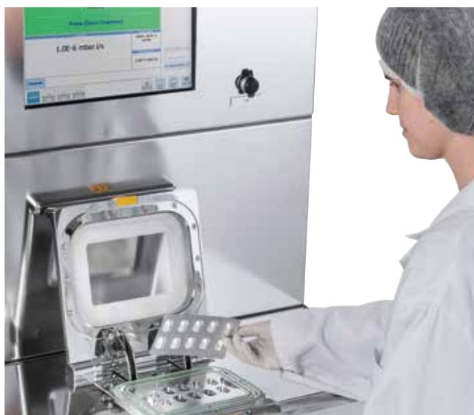
Abbildung 1: Prüfkammer und Benutzerschnittstelle eines AMI Dichtheitsprüfsystems
