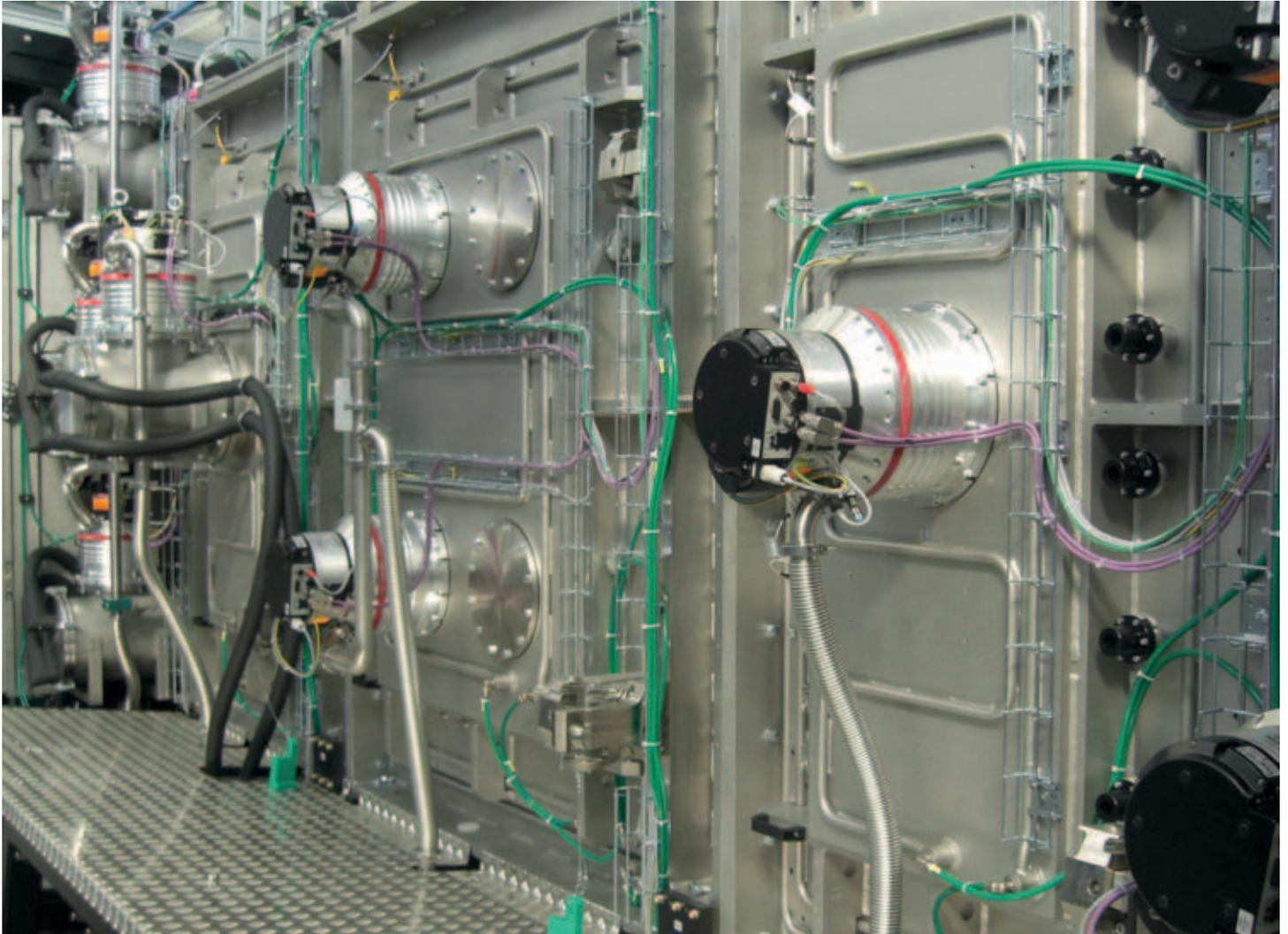
Abbildung 2: Anlage von Leybold Optics zur Glasbeschichtung mit HiPace Turbopumpen von Pfeiffer Vacuum
