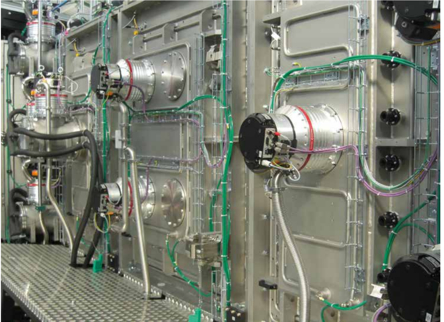
그림 2: 파이버 베콤의 HiPace 터보 펌프를 사용하는 Leybold Optics의 유리 코팅기
