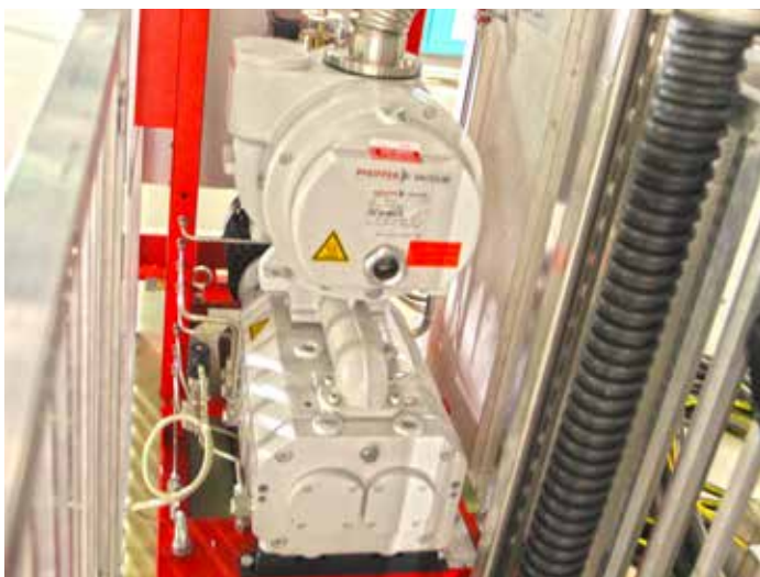
Turbopumpen, Pumpstände, Massenspektrometer und Analytoren von Pfeiffer Vacuum im Einsatz bei Wendelstein 7-X
