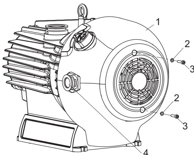
**Abb. 19: Zylinderschrauben herausschrauben**
