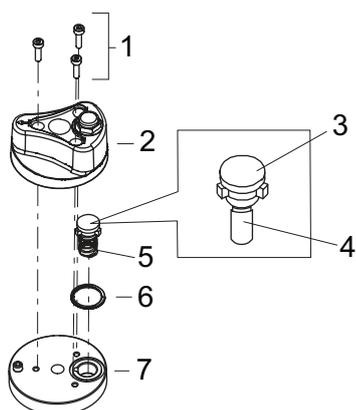
**Abb. 26: Gasballastventil zusammenbauen**
