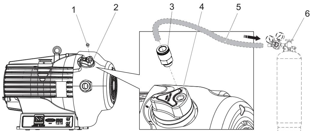
Abb. 8: Externe Gasballastversorgung anschließen
