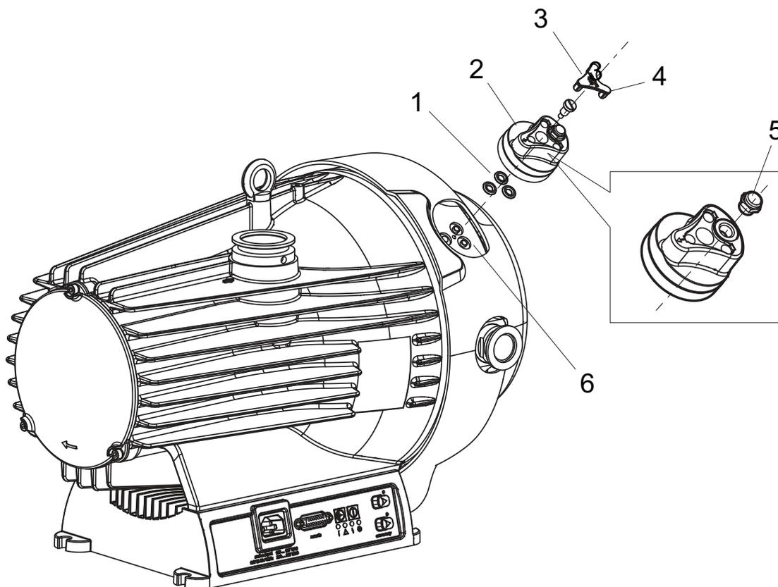
**Abb. 24: Gasballastventil demontieren**
