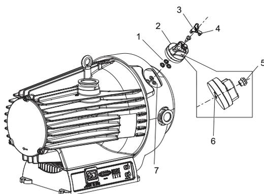
**Abb. 27: Gasballastventil montieren**
