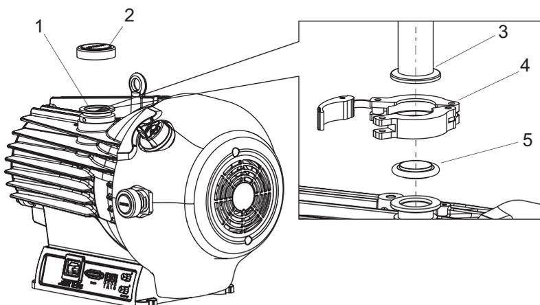
Abb. 6: Beispiel für den Vakuumanschluss
