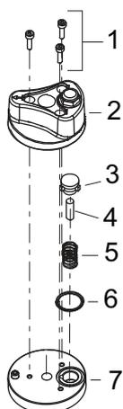
**Abb. 25: Gasballastventil demontieren**
