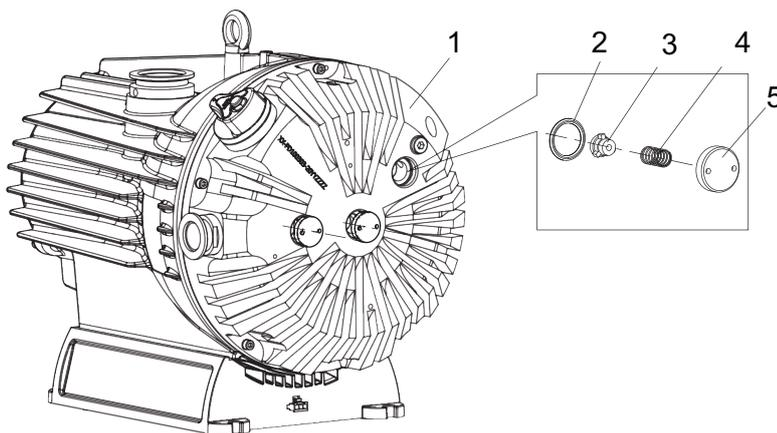
**Abb. 22: Ventile demontieren**
