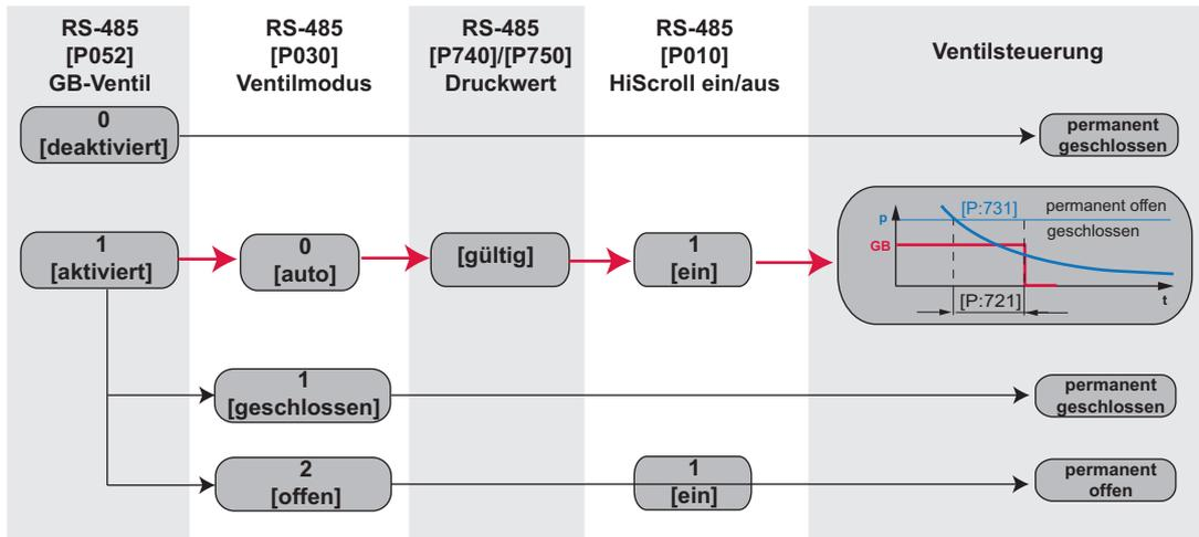
Abb. 17: Druckabhängige Gasballastventilsteuerung im Automatikmodus
