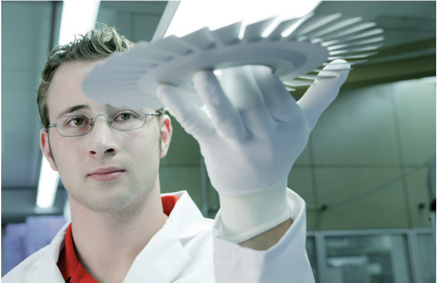
Kontrolle einer Rotorscheibe
