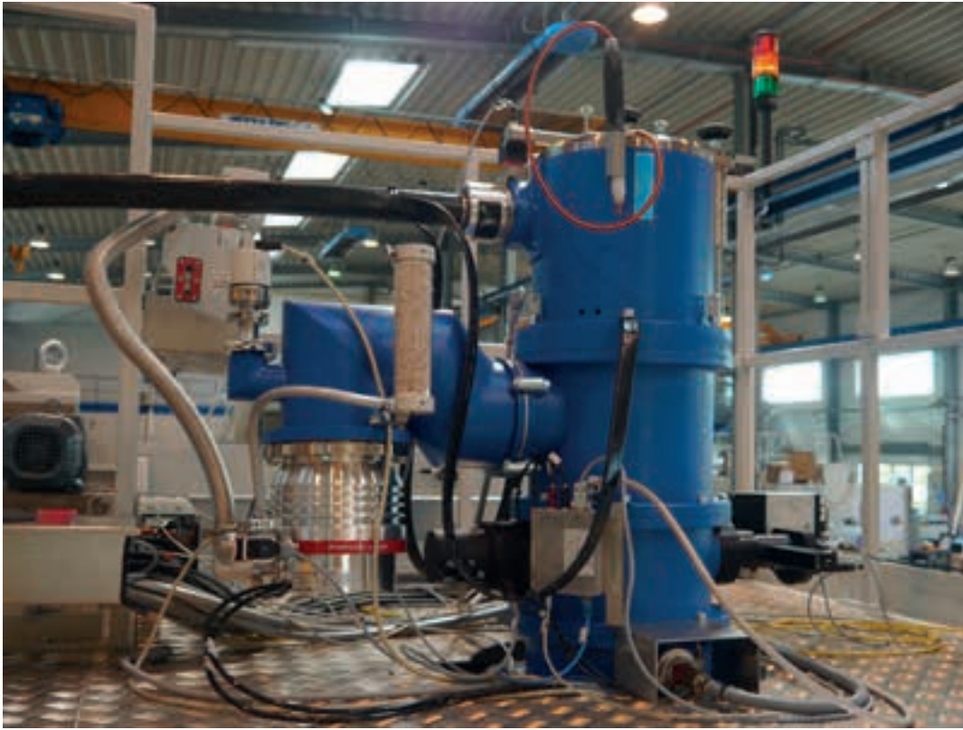
전자빔 발생기에 설치된 HiPace 터보 분자 펌프 (Steigerwald Strahltechnik 의 허가를 받음)
