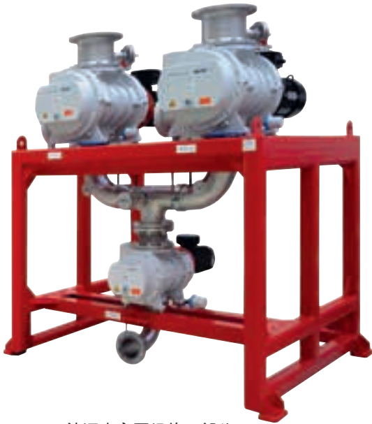
图 2：ATEX 认证真空泵组的一部分
