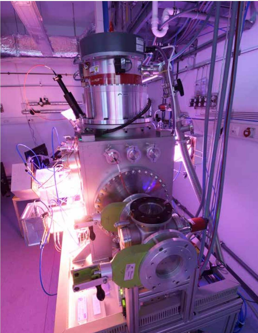
图 3：2DIBS 设施，有多个射频离子源，用于利用离子束溅射沉积对基材进行双面镀膜。该系统还配备了两台型号为 ATH3204M 的涡轮分子泵及 ACP 28 多级罗茨干泵作为前级泵。
