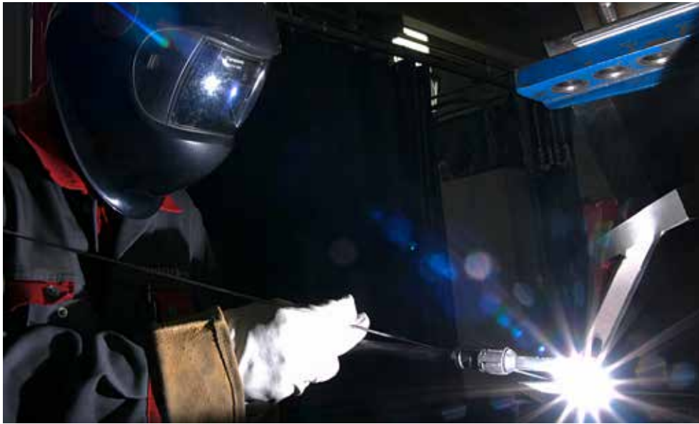
진공 구성품의 용접
