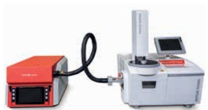
Abbildung 2: Kopplung einer Mettler-Toledo TGA/DSC 3+ mit einem Pfeiffer Vacuum ThermoStar GSD 350
