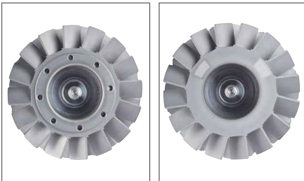
Abbildung 3: Vergleich einer Wuchtebene des konventionellen Wuchtens (links) mit Wuchtbohrungen und des Laserbalancing (rechts) mit Laserablationssegmenten
