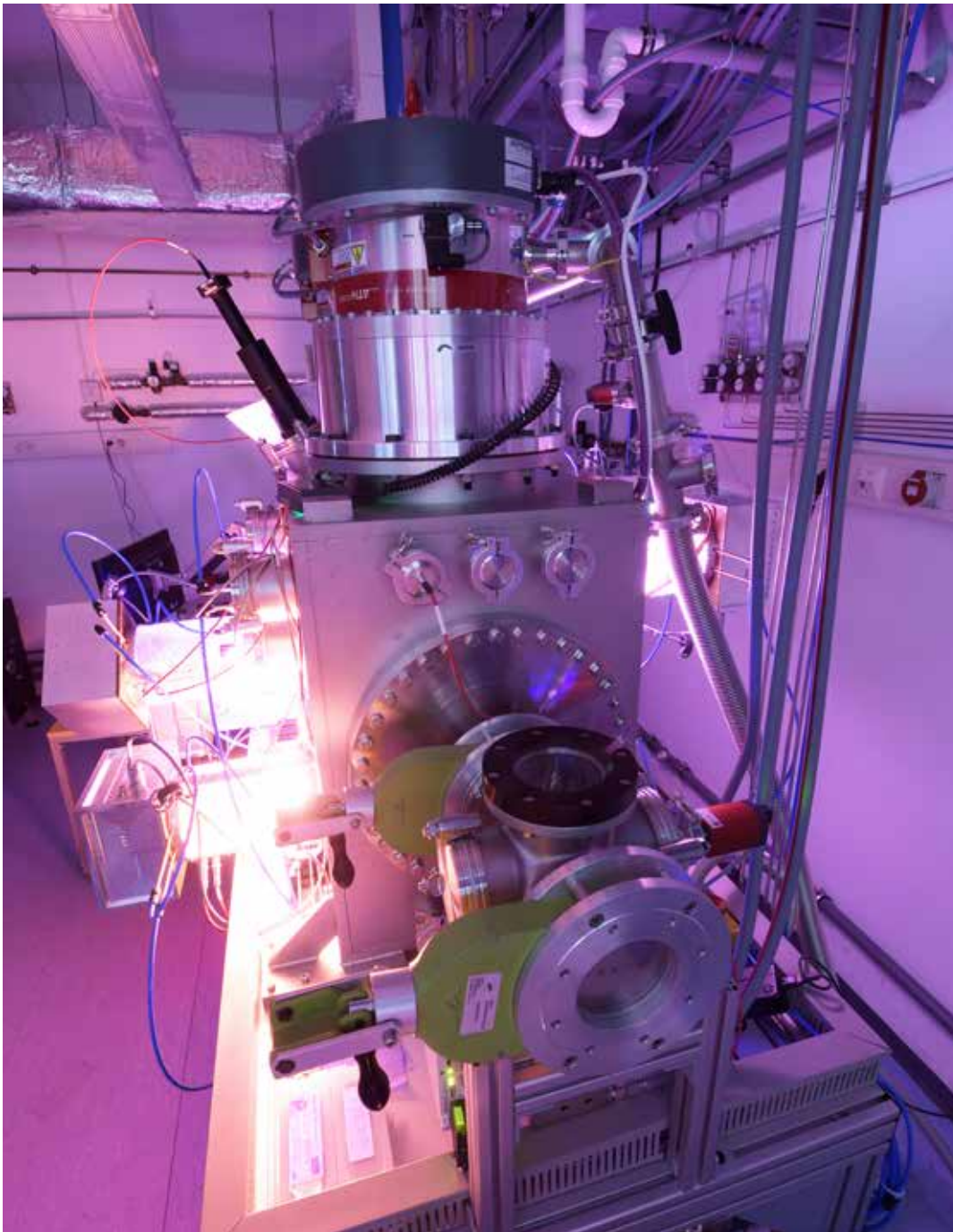
Abbildung 3: 2 DIBS-Anlage mit mehreren RF-Ionenquellen für das beidseitige Beschichten von Substraten mittels Ionenstrahlsputterdeposition. Auch diese Anlage ist mit zwei Turbopumpen des Typs ATH 3204 M mit ACP 28 Vorpumpen ausgestattet.
