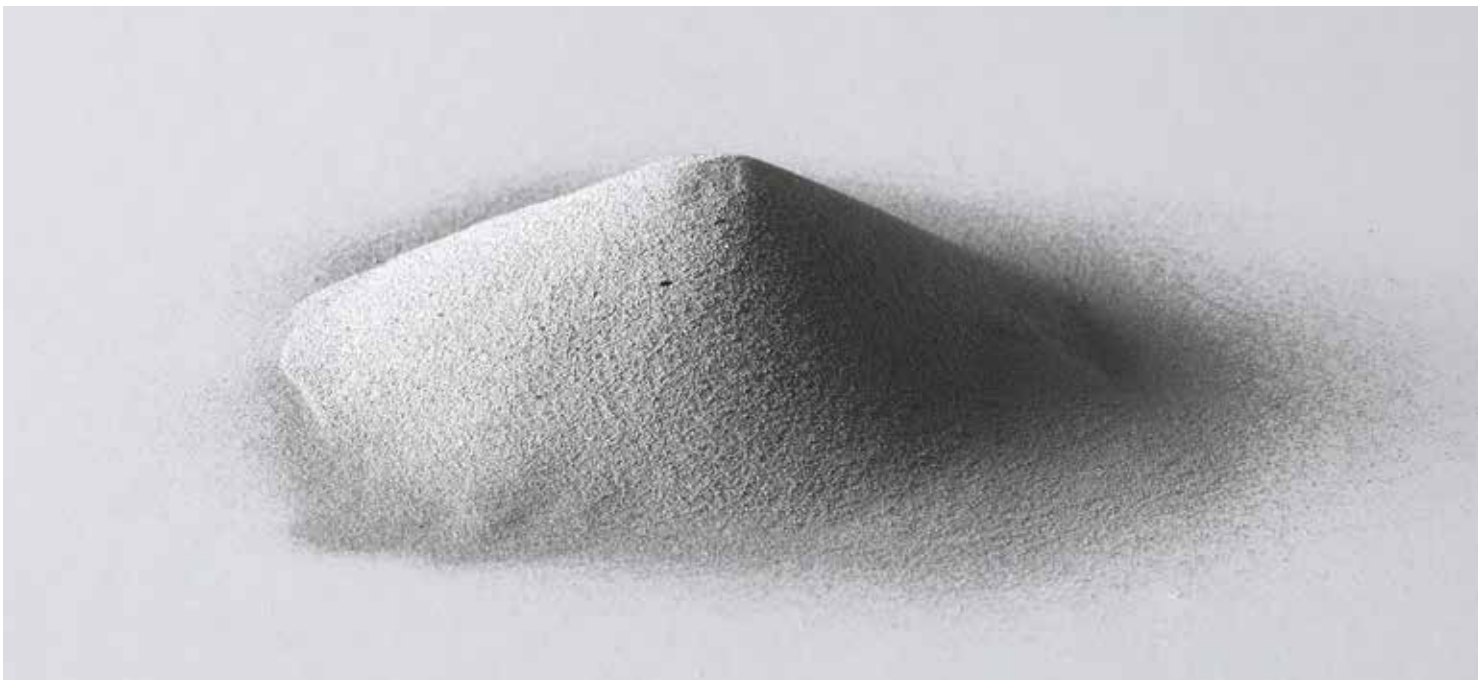
Abbildung 4: Metallpulver für den 3D-Druck; häufig werden Legierungen aus Titan und Kobalt-Chrom eingesetzt
