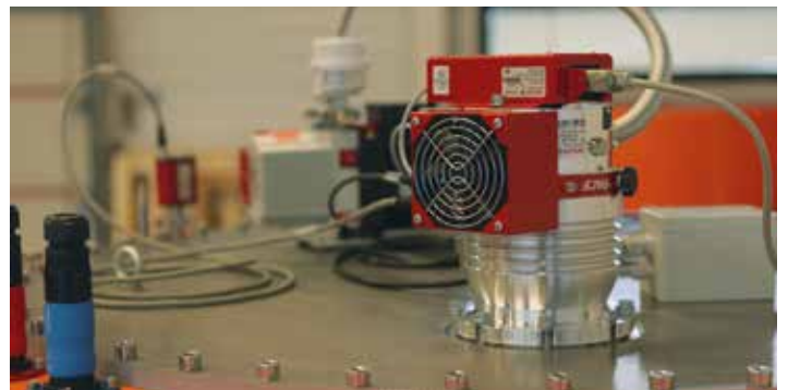
图 5：普发真空的涡轮分子泵、旋片泵和皮拉尼真空计用于 Levisys 系统
