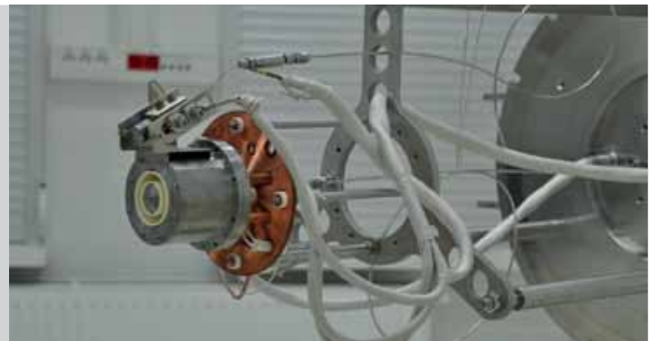
Abbildung 3: Am IFPILM getestetes Hall-Triebwerk
