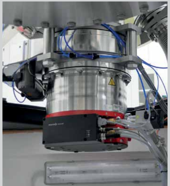
Abbildung 5: HiPace MC Turbopumpe
