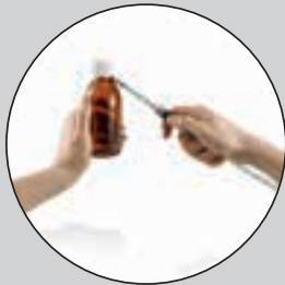
吸枪检测定位漏点
