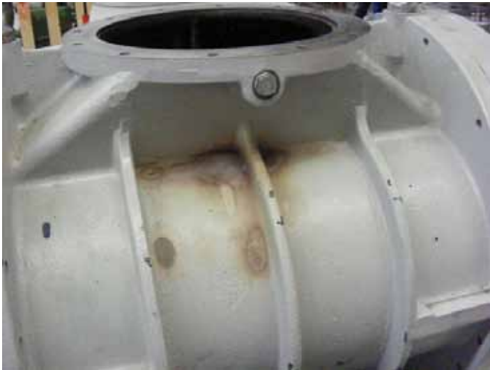
그림 1 및 2: 극한 압력으로 전환하고 그 결과 발생한 국소 과열로 인해 멈춘 루츠 펌프
