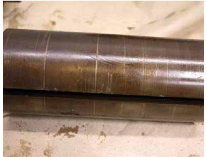
그림 3 및 4: 먼지 필터가 없는 회전 날개 펌프의 유입구 회전자가 실린더에 의해 변색되었습니다. 펌프 시스템을 교체해야 합니다.
