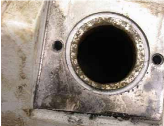
그림 3 및 4: 먼지 필터가 없는 회전 날개 펌프의 유입구 회전자가 실린더에 의해 변색되었습니다. 펌프 시스템을 교체해야 합니다.
