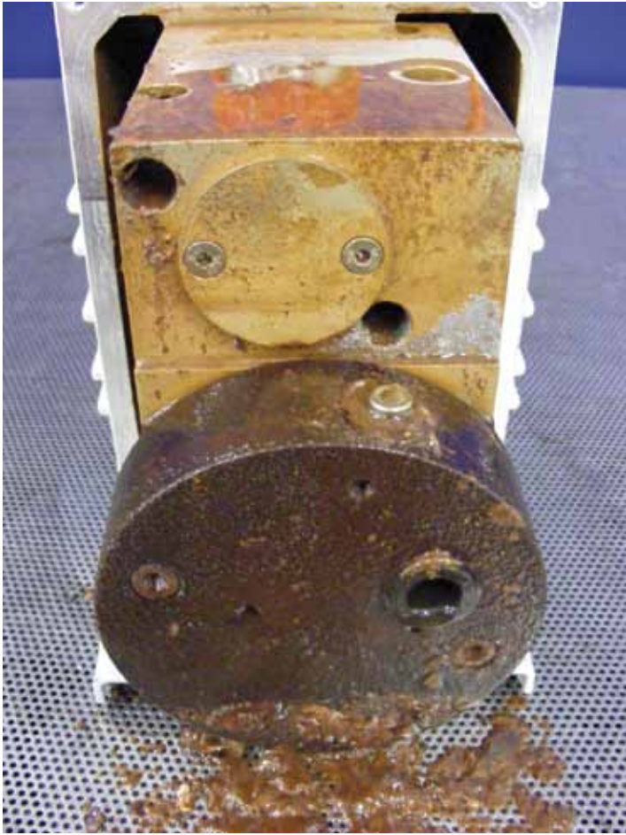
그림 1: 기체 밸러스트 없이 작동하여 심하게 부식된 회전 날개 펌프
