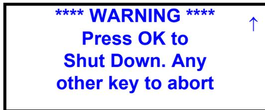
Beim Drücken der Taste OK/SEL wird die Turbopumpe abgeschaltet.
