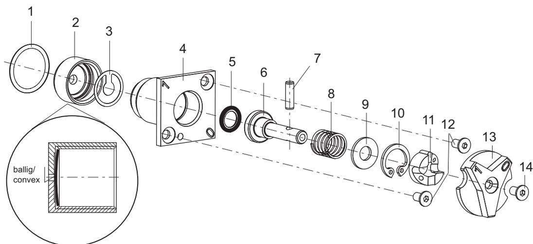
**Fig. 15: Gas ballast valve**
