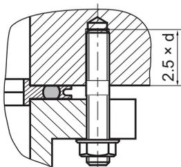
图片 12: 法兰连接 ISO-F, 螺杆和螺纹孔
