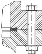
图片 14: CF-F 法兰连接, 六角头螺钉和通孔
