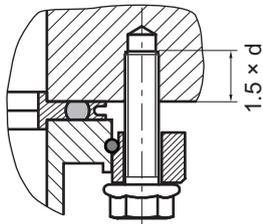
图片 8: ISO-K 到 ISO-F 的法兰连接、六角头螺钉和螺纹孔
