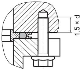
图片 11: 法兰连接 ISO-F, 六角头螺钉和螺纹孔
