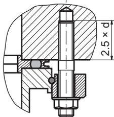
图片 9: ISO-K 到 ISO-F 的法兰连接、螺杆和螺纹孔
