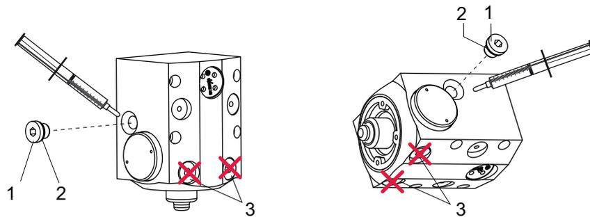
图片 18: 工作液灌装螺栓的位置取决于涡轮泵的方向
