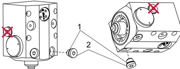
图片 23: 工作流体排放塞的位置取决于涡轮泵的方向
