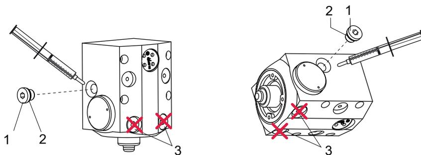
图片 24: 工作液灌注螺栓的位置取决于涡轮泵的方向
