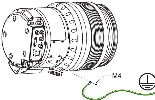
图片 21： 示例:连接接地电缆
