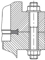
图片 16: CF-F 法兰连接, 螺杆和通孔
