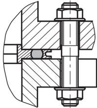
图片 13: ISO-F 法兰连接, 螺杆和通孔
