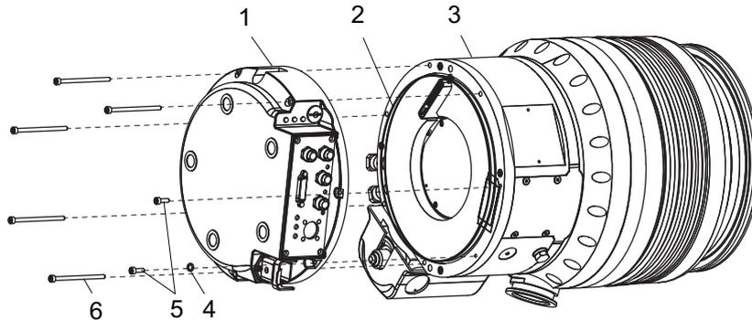
图片 25： 更换电子驱动单元 - 拆除
