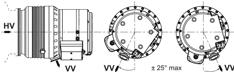
图片 6: 前置真空连接必须与水平安装方向一致
