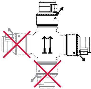
图片 5: U 型涡轮泵的安装方向(架空)
