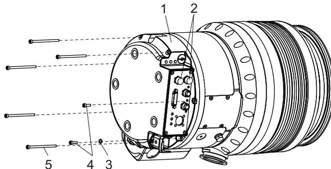
图片 27： 更换电子驱动单元 - 紧固
