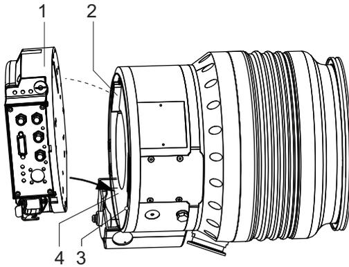
图片 26： 更换电子驱动单元 - 安装
