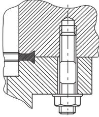
图片 15: CF-F 法兰连接, 螺杆和螺纹孔
