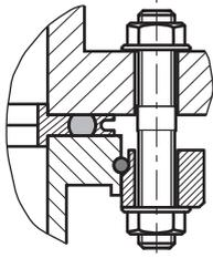
图片 10: ISO-K 到 ISO-F 的法兰连接、螺杆和通孔
