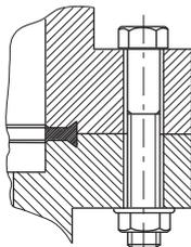
**Abb. 12: Flanschverbindung CF-F, Sechskantschraube und Durchgangsbohrung**
