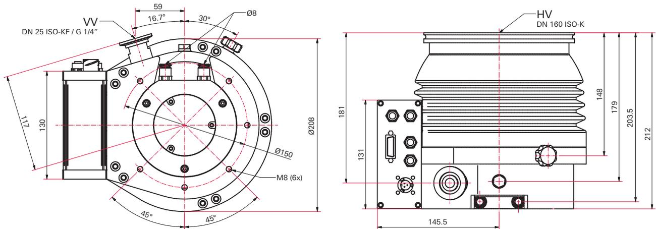
Abb. 24: Abmessungen HiPace 700 | TC 400 | DN 160 ISO-K
