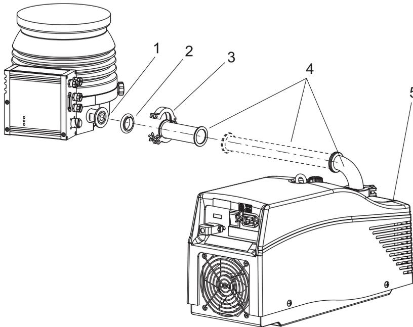
Abb. 15: Beispiel für den Vorvakuumanschluss an HiPace 700
