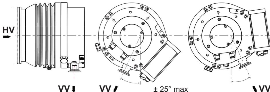
Abb. 4: Empfohlene Ausrichtung bei Verwendung ölgedichteter Vorpumpen
