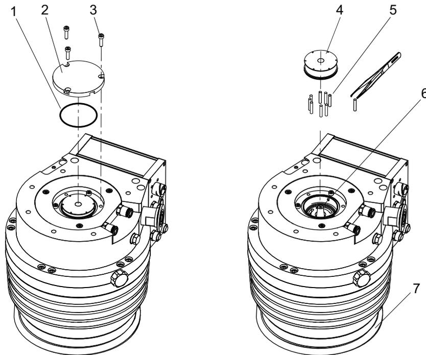
**Abb. 19: Betriebsmittelspeicher demontieren**
