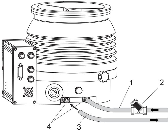
**Abb. 16: Kühlwasserversorgung anschließen**
