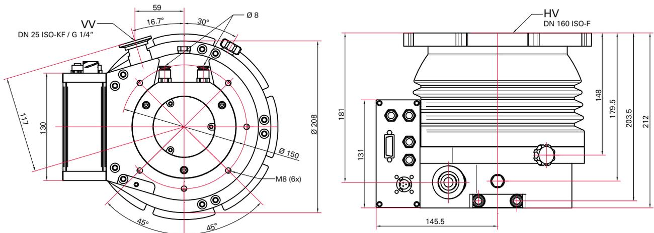
Abb. 26: Abmessungen HiPace 700 | TC 400 | DN 160 ISO-F
