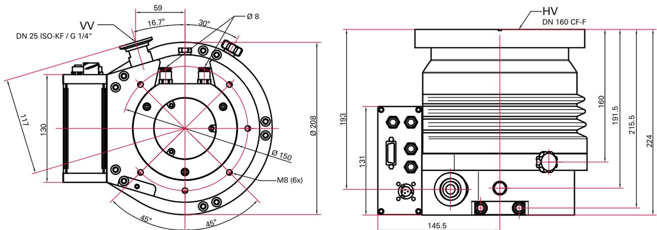
Abb. 25: Abmessungen HiPace 700 | TC 400 | DN 160 CF-F
