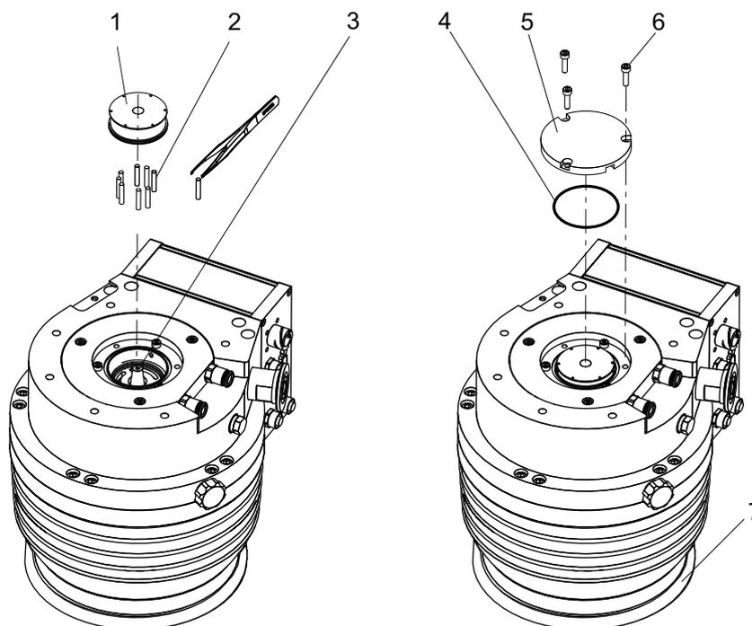
Abb. 20: Betriebsmittelspeicher montieren
