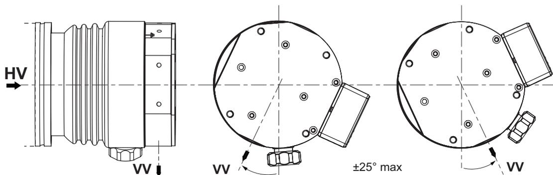
Abb. 4: Empfohlene Ausrichtung bei Verwendung ölgedichteter Vorpumpen
