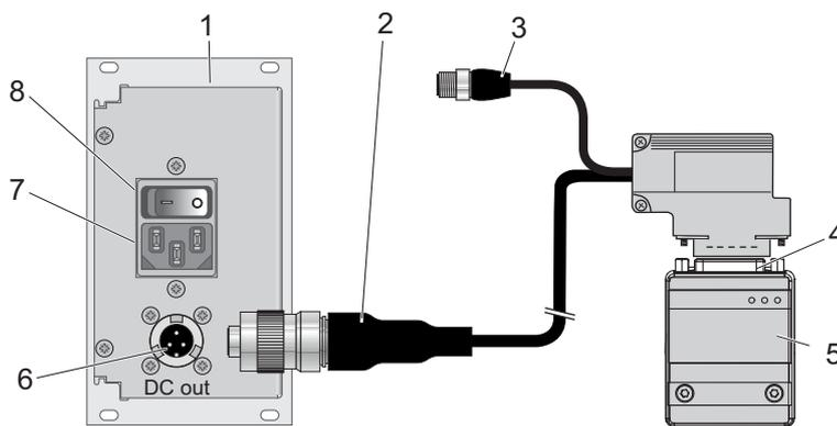
**Abb. 17: Antriebselektronik mit Netzteil verbinden**
