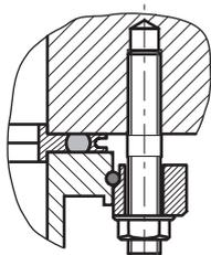
**Abb. 9: Flanschverbindung ISO-K mit ISO-F, Stiftschraube und Gewindebohrung**
