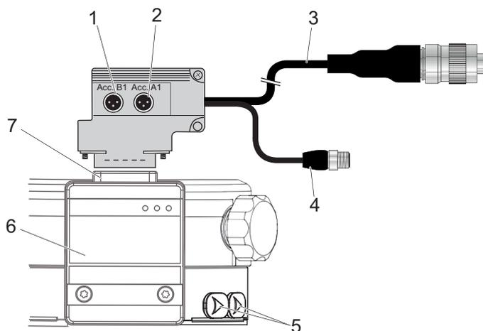
Abb. 15: Zubehöranschluss über Verbindungskabel
