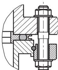
**Abb. 10: Flanschverbindung ISO-K mit ISO-F, Stiftschraube und Durchgangsbohrung**
