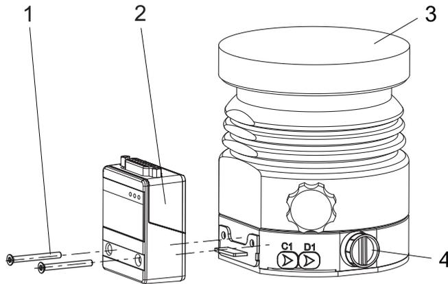
**Abb. 20: Demontage und Montage der Antriebselektronik**
