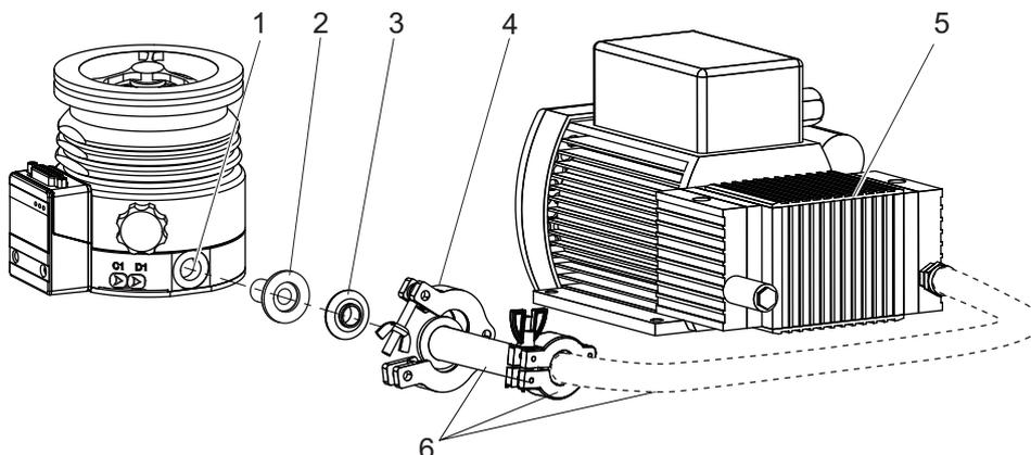
**Abb. 14: Beispiel für den Vorvakuumanschluss an MVP**
