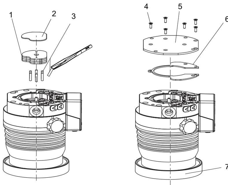
Abb. 19: Betriebsmittelspeicher montieren
