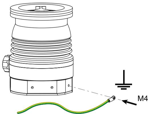
Abb. 16: Beispiel: Anschluss des Erdungskabels
