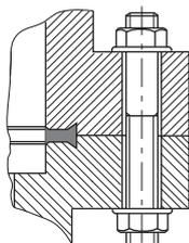
**Abb. 13: Flanschverbindung CF-F, Stiftschraube und Durchgangsbohrung**
