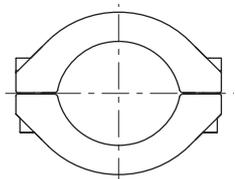
Abb. 5: Flanschverbindung ISO-KF mit Spannring
