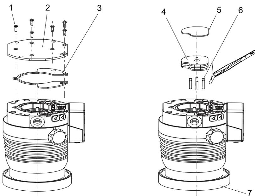
**Abb. 18: Betriebsmittelspeicher demontieren**
