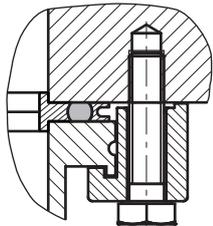
**Abb. 7: Flanschverbindung ISO-K mit ISO-F, Pratze und Gewindebohrung**
