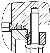
**Abb. 8: Flanschverbindung ISO-K mit ISO-F, Sechskantschraube und Gewindebohrung**
